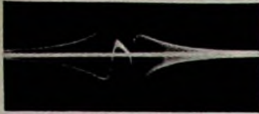
Abb. 4. Der Frequenz-Hub ist mit der Bandbreite des Oszillografenverstärkers vergleichbar
