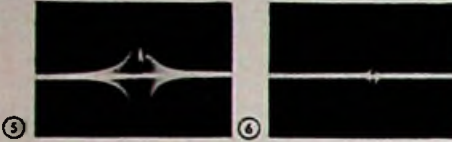
Abb. 5. Der Frequenz-Hub ist größer als die Bandbreite
